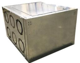
Collettore utilizzabile sia per le mandate che per le riprese, isolato termicamente ed acusticamente all'interno, comprensivo di 4 staffe a squadra per il montaggio. Utilizzabile sia dritto che a 90°. Abbinabile a tubi tondi DN 63/75/90.
