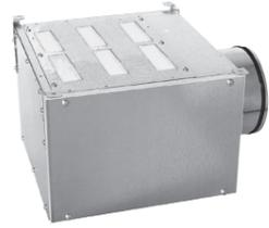
Collettore utilizzabile sia per le mandate che per le riprese, isolato termicamente ed acusticamente all'interno, comprensivo di 4 staffe a squadra per il montaggio. Utilizzabile sia dritto che a 90°. Abbinabile a tubi piatti 132 x 52 mm e a riduttori di portata statici.
