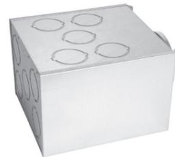
Collettore utilizzabile sia per le mandate che per le riprese, isolato termicamente ed acusticamente all'interno, comprensivo di 4 staffe a squadra per il montaggio. Utilizzabile sia dritto che a 90°. Abbinabile a tubi tondi DN 63/75/90.
